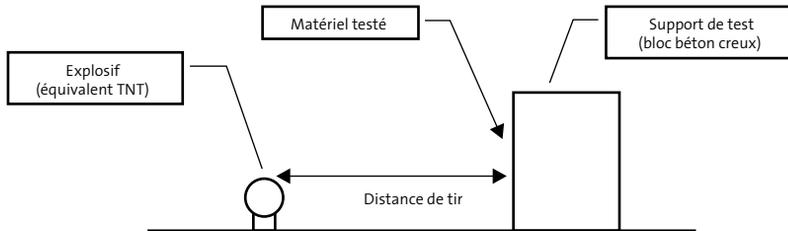
Pour garantir la résistance d'un matériau, il faut que le châssis, les remplissages, ainsi que la serrure, dans le cas d'une porte, soient testés ensemble. Fichet s'y engage dans ses programmes d'essais.
