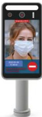
Intégré à l'obstacle, le module d'affichage 7" de la borne H-Sense T combine l'analyse d'image et la détection thermique pour informer l'opérateur et/ou l'utilisateur des résultats d'une détection sans contact mais professionnelle : plage de mesure de 30 à 45°C et précision de  $\pm 0,3^{\circ}\text{C}$ .
